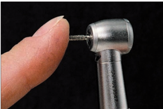
Инструменты не должны шататься в турбине. The instruments should not wobble in the dental handpiece.
